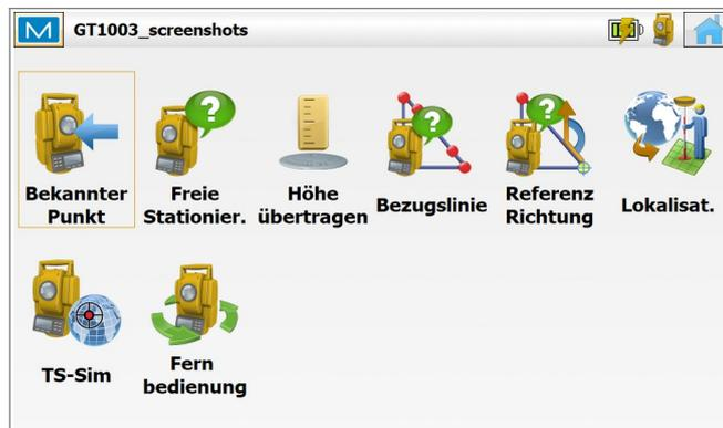
Der Menüpunkt **Fernbedienung** erlaubt es, die Totalstation via Remote Control vom Feldrechner aus zu bewegen, ähnlich wie mit einem Joystick.
